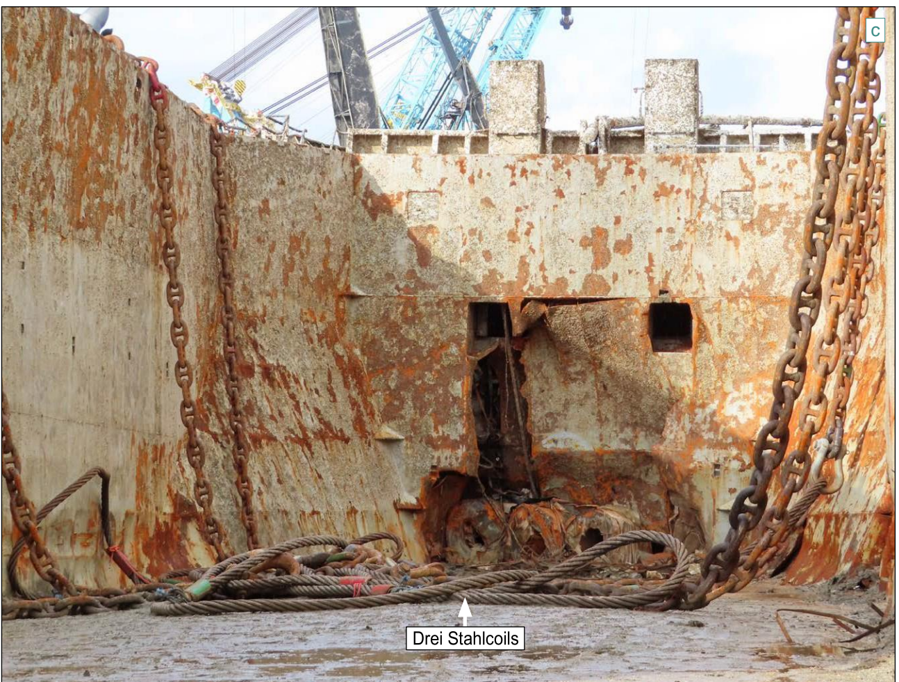
Abbildung 13: Schäden am Rumpf der Verity (a und b) und Stahlcoils vorne im Laderaum (c)
