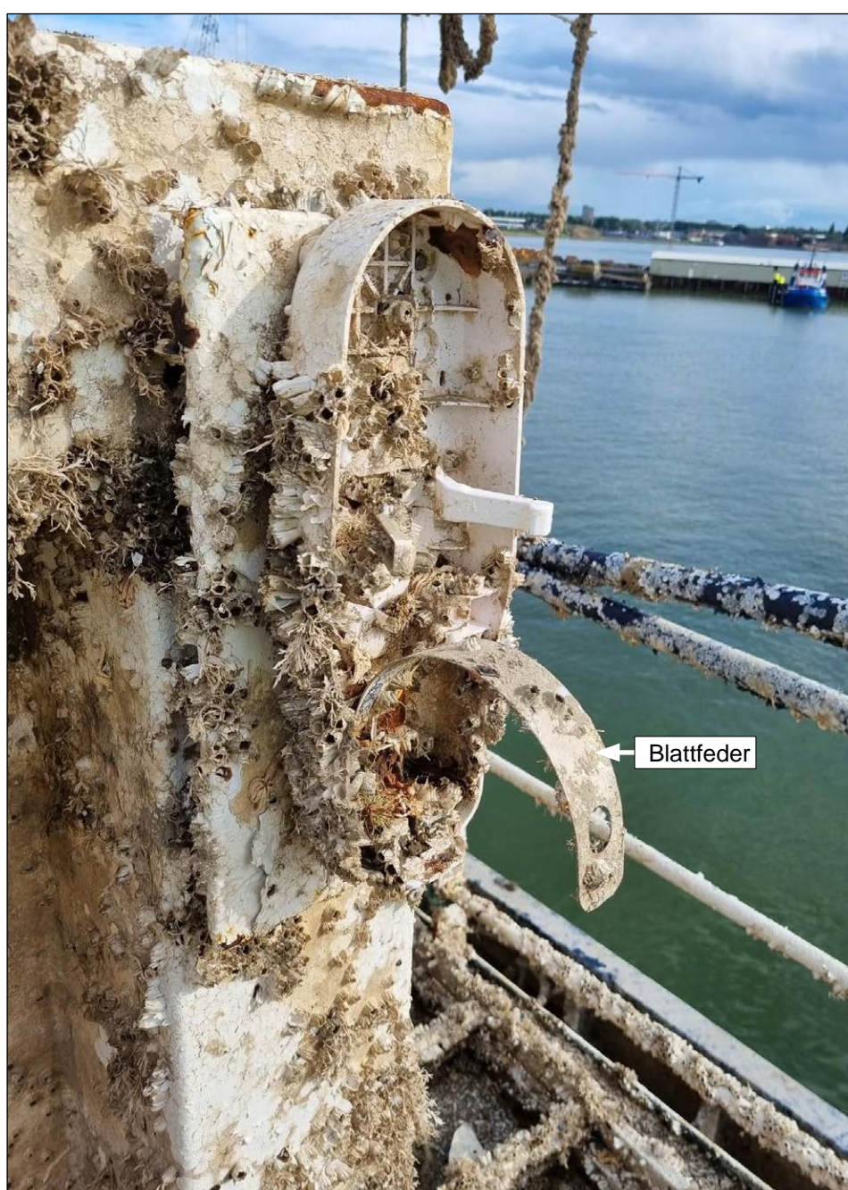
Abbildung 15: EPIRB-Halterung mit fehlendem Deckel und aktivierter Auswurfblatfeder
