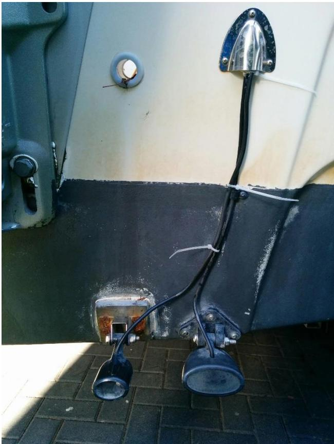
Nochmal Heckgeber, montiert auf geklebter Montageplatte
