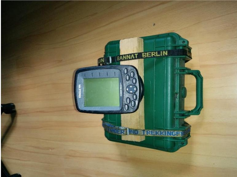
Fertig zur mobilen Nutzung, Geberanschluss hinten und on/off-Schalter
