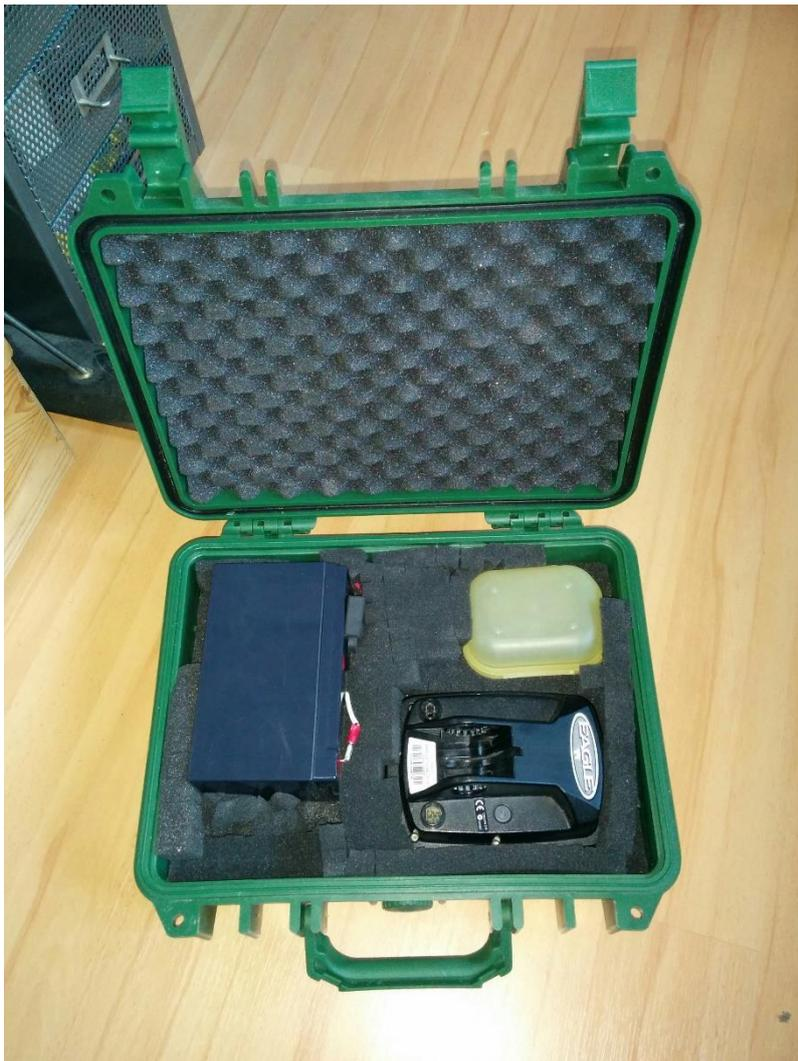
wasserdichter Koffer von PEARL sowie Gelakku und Cuda 350i (Anschlüsse hinten)
