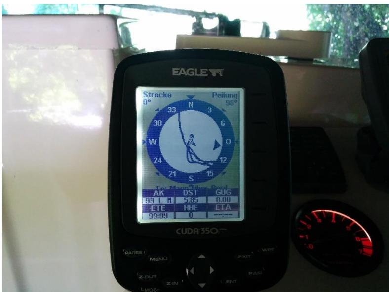
Navigationsschirm mit Steuerkurs und Track sowie Fahrdaten
