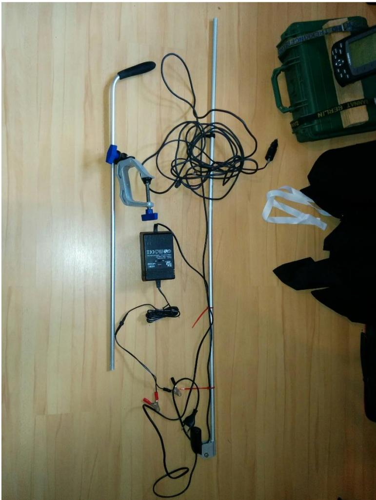
Geberstange mit Halterung (ca. 80 cm und unbenutzt), dazu Zusatzgeberstange mit Geber (ca. 120 cm) sowie Anschluss an Koffer (Stromversorgung) und Anschluss an EAGLE Cuda 350i
