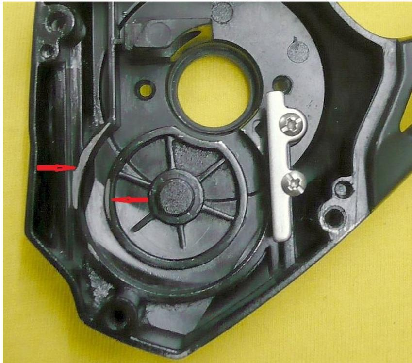
Die abgeschleuerten Stellen am Gehäuse sind verursacht durch Auflage des Exenterrads auf das Gehäuse unter Belastung. Beim Kurbeln wird dann Material vom Gehäuse abgetragen. Wie kann es dazu kommen? Das ist konstruktionsbedingt und durch Fertigungstoleranzen verursacht.
