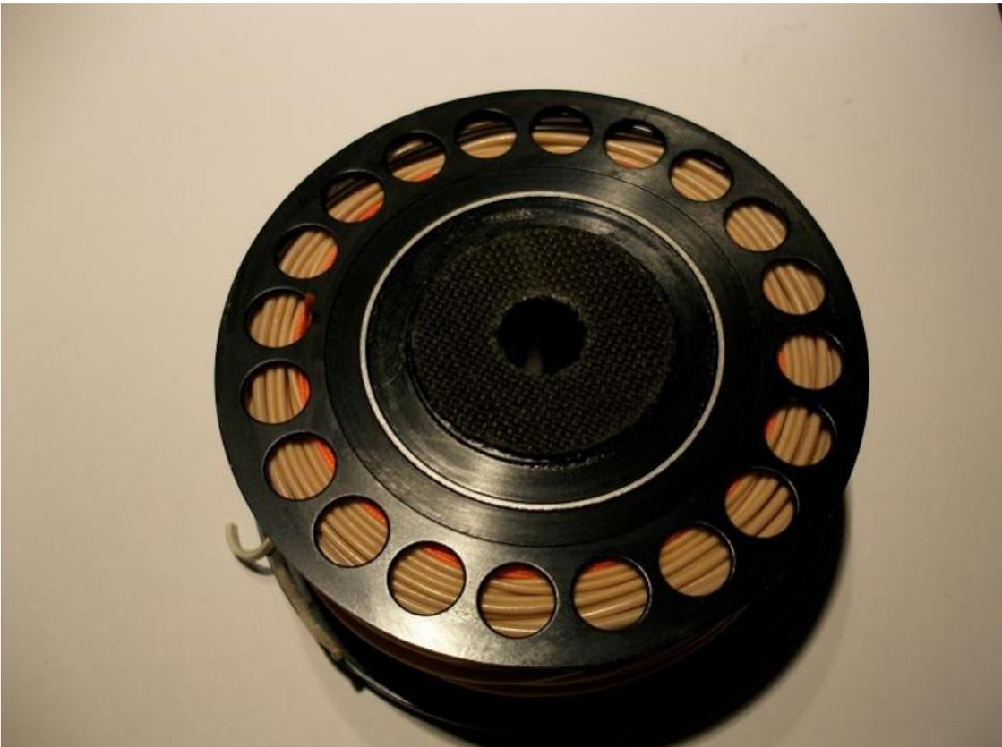
Jetzt wurde die Bremsmatte noch mit Cal's reichlich gefettet und mit einer Zahnbürste in die Fasern gearbeitet.
