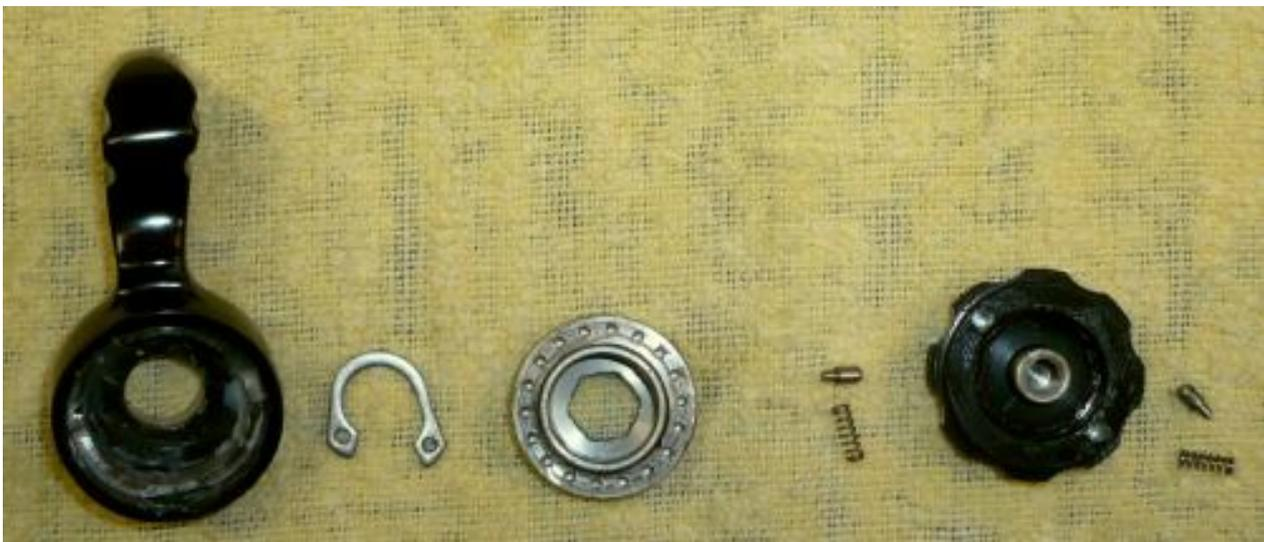
Teile des Bremshebels. Bei der Demontage auf die beiden Ratschenpins und Federn achten!!! Zum Lösen des C-Clips eine dafür notwendige Zange nehmen. Nicht herumwürgen sonst ist der Clip schnell verbogen.
