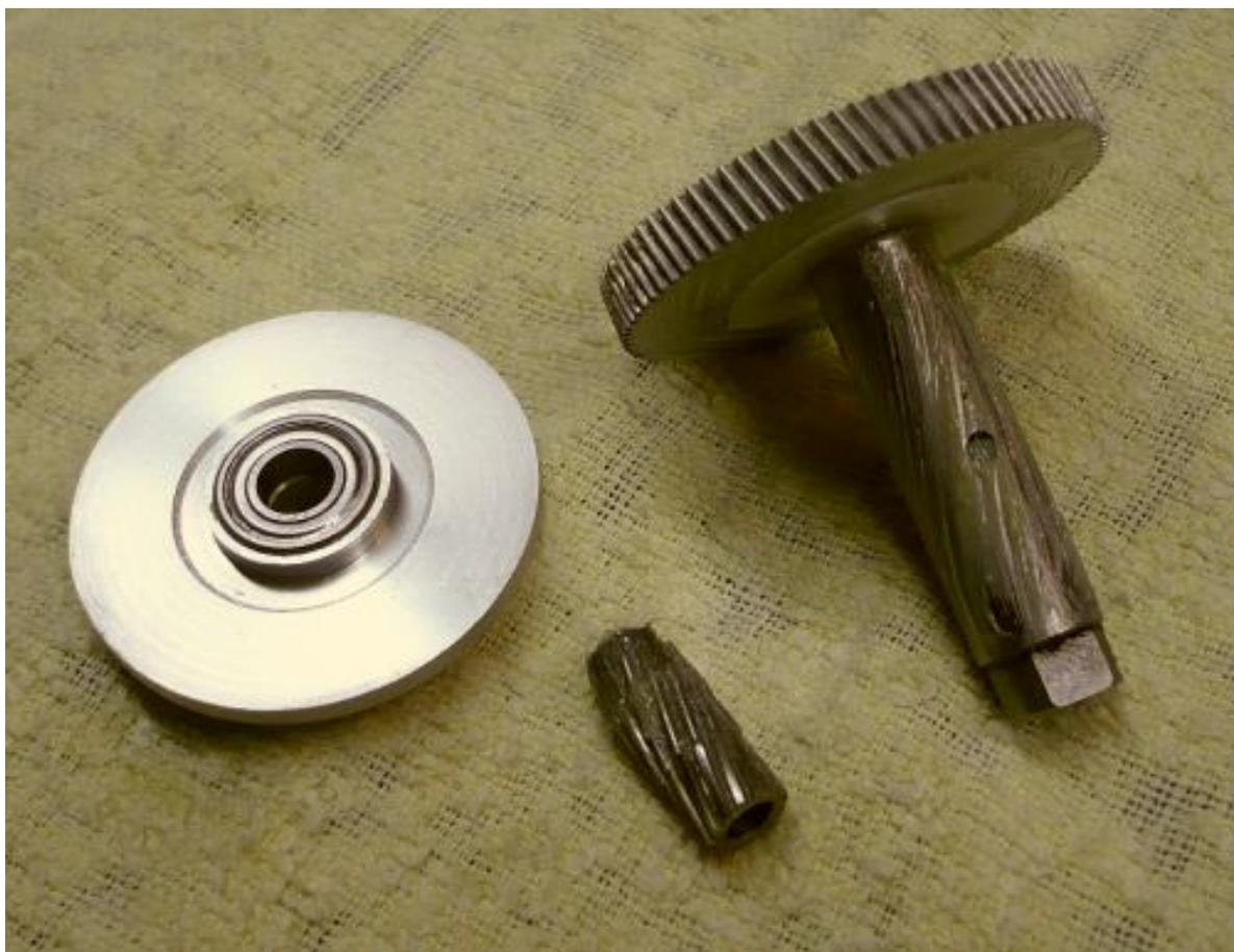
Druckplatte mit eingesetztem KL; schrägverzahntes Ritzel u. Zahnrad
