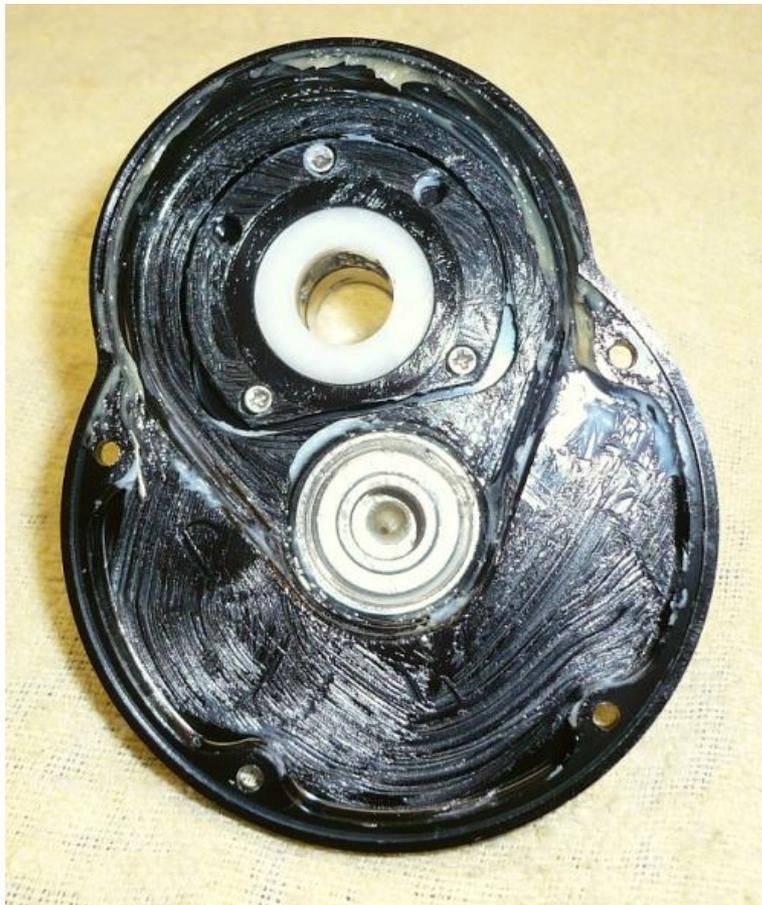
Gehäusedeckel. Gut zu sehen das innere Teflonlager, die dahinter steckende Rücklaufsperr und das vordere Teflonlager. Sehr positiv das große Kugellager für die Aufnahme des Ritzel welches die Kräfte beim Kurbeln besser verträgt und dadurch langlebiger ist.
