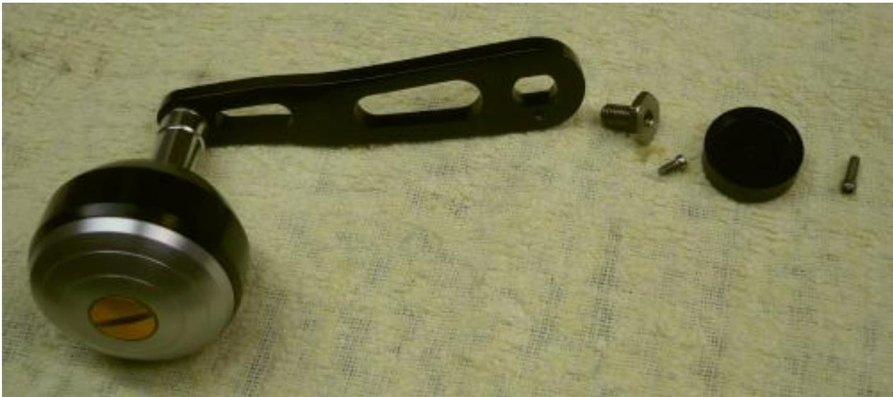
Kurbel, Befestigungs- u. Sicherungsschraube, Abdeckkappe und Schraube zur Befestigung der Abdeckkappe. (v.l.)
