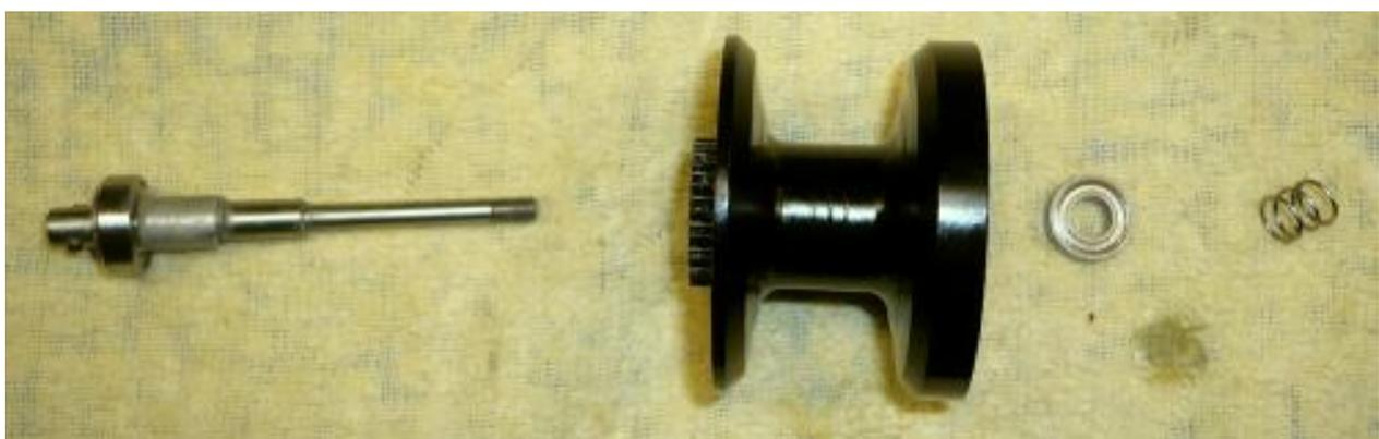
v.l. Achse, KL, Spulenhülse, Spule, KL, Druckfeder
