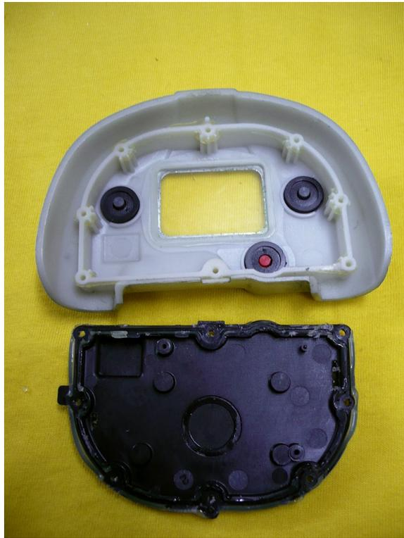
Display mit Abdeckkappe. Blick auf die Unterseite der drei Bedienknöpfe welche auf die drei markierten Schalter im nächsten Bild aufliegen.
