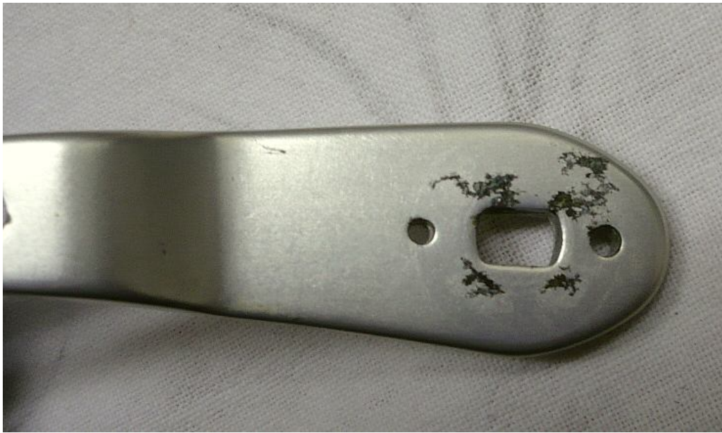
Lochfraß an der Unterseite der Kurbel
