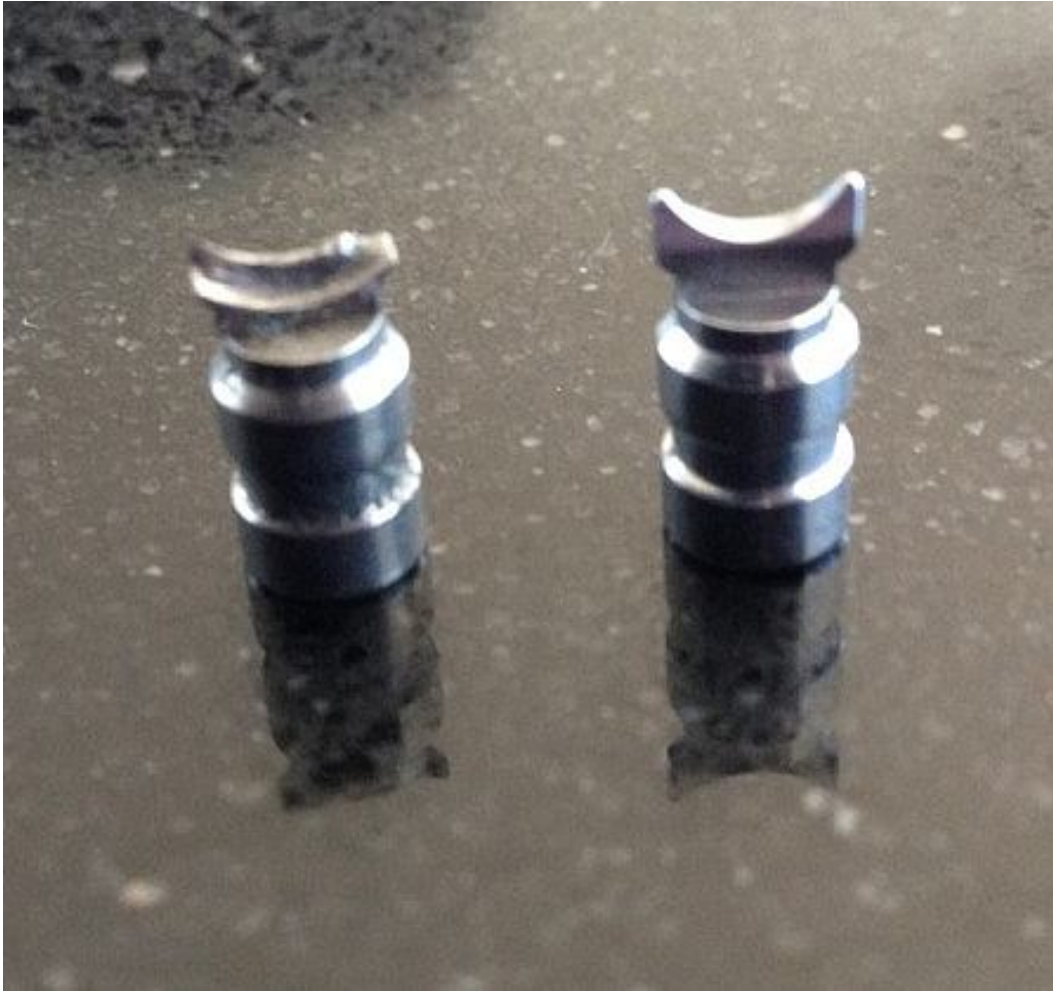
links abgenutzter Line Guide Pawl
