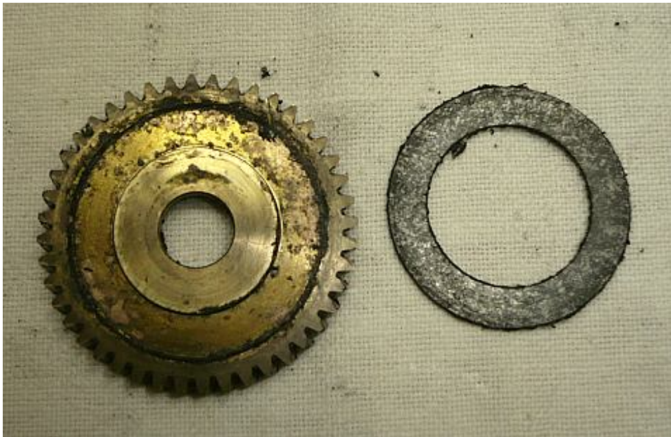
die Bremscheiben befinden sich in Auflösungserscheinung
