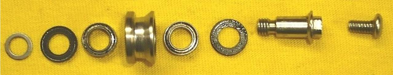
Distanzscheibe, Dichtung, Kugellager, Röllchen, Kugellager, Dichtung, Aufnahmeachse, Schraube
