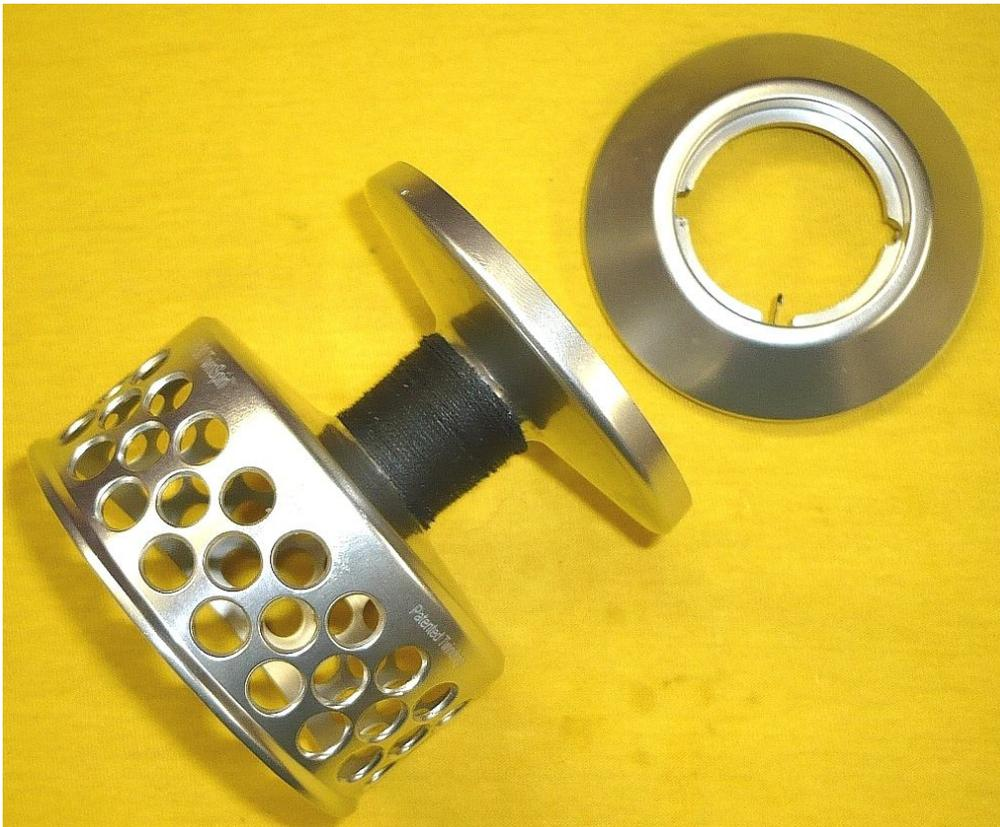
Spule mit abschraubbarer Abdeckkappe, deckt die obere Bremseinheit ab
