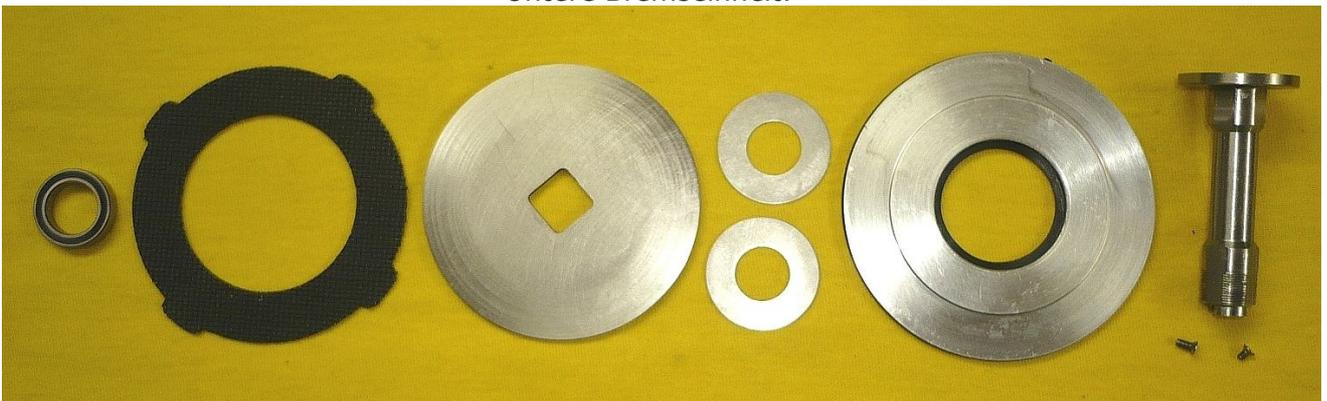
Kugellager, CFK Bremsscheibe, Bremsdruckplatte, Distanzscheiben, Abdeckkappe, Spulenaufnahme der oberen und unteren Bremseinheit, Konterschrauben der Bremseinstellmutter (v.l.n.r.)
