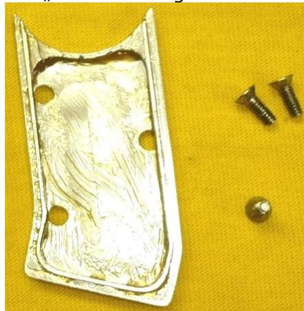
Gegen Eindringen von Seewasser und Korrosion sollten die Unterseite des Deckel, der Innenraum und die drei Schraubengewinde gefettet werden
