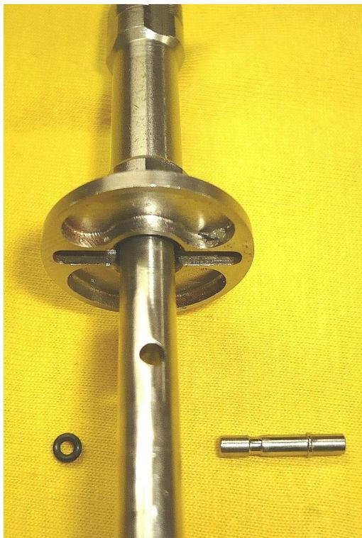
Die Spulenaufnahme auf auf der Achse, mit Haltestift und Sicherungsring
