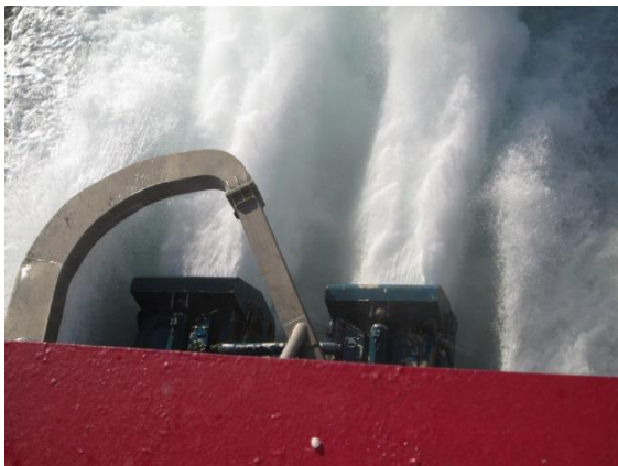
Der Jet-Antrieb der Fjordline Fähre
