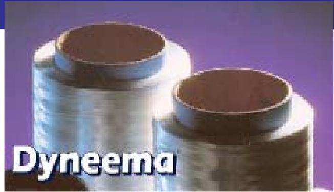
und prakt. unmöglich zu Schleifen. Aufgrund dieser Nachteile werden Dyneema-Fasern und Gewebe für hochbelastete Teile im Faserverbundbereich kaum eingesetzt, ausser zur Erhöhung der Schlagzähigkeit. Die Fasern sind jedoch ideal anwendbar für Ballistische Teile wie Panzerungen, Militärhelme, Kugelschutzwesten und ähnliches sowie für die Herstellung von Tauwerk, Seilen und Schnüren.
