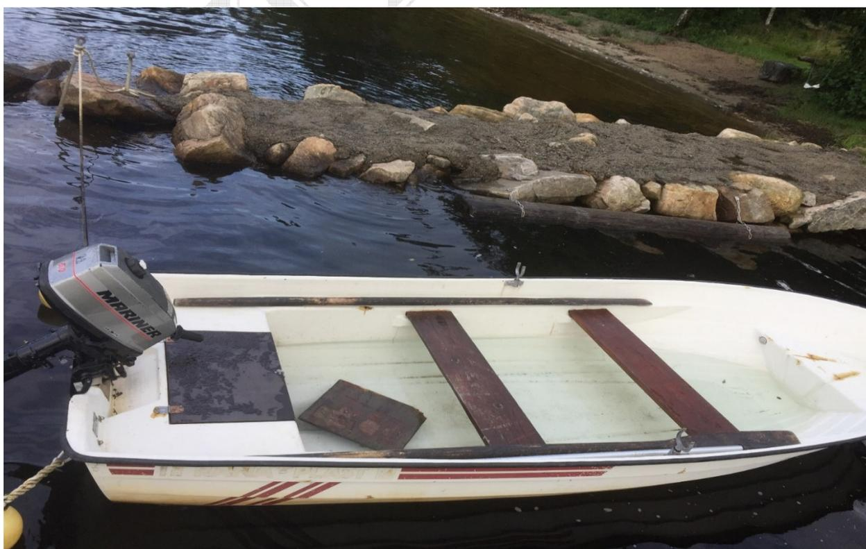
Bild 20: Bei 300 kg Wasserlast immerhin noch 20 cm Freibord
