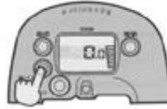
„Line-Feed“ funktioniert nur wenn die Stromzufuhr aktiv ist. Zum Ausschalten von „Line Feed“ drücken Sie Knopf C. Das Display zeigt die folgenden Meldungen:
