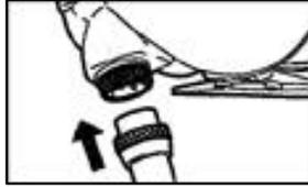
**Schritt 3:** Nach korrektem Anschluß ertönt ein Piepton und das Display leuchtet auf. Nach dem ersten Anschließen, wenn noch keine Schnurdaten einprogrammiert sind, sehen Sie diese Displaymeldung.
