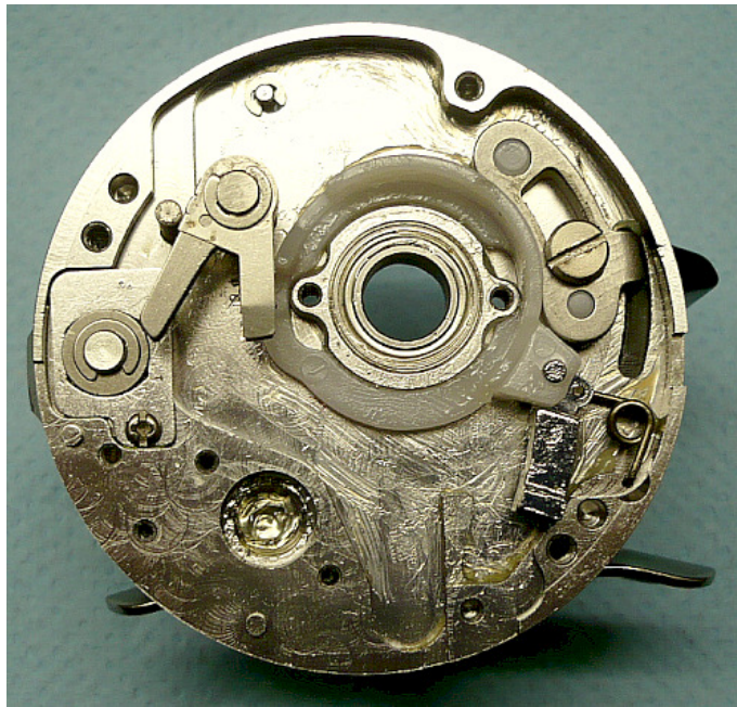
Blick in das Gehäuse. Das Pinion Gear ist kugelgelagert!
