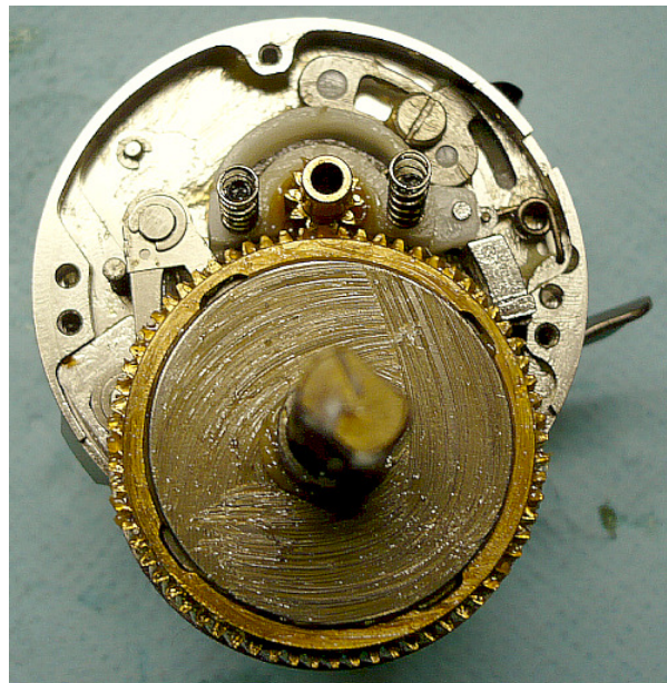
Blick auf das Getriebe (so gefettet war die beim Zusammenbau)
