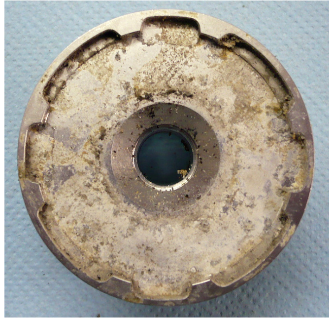
Spule, kurbelseitig starke Salzablagerungen und Korrosion
