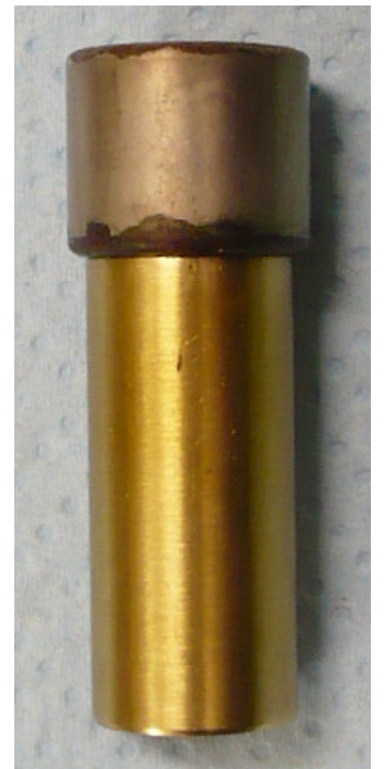
Gereinigter Gehäusedeckel. Die Rücklaufsperr ist verrostet und knirscht beim Kurbeln. Aus der Hülse gepresst, neues Lager ist bestellt.
