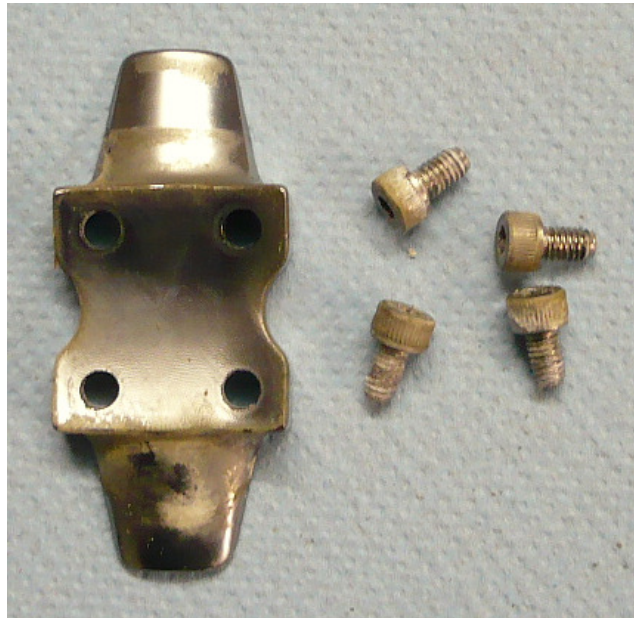
Rollenfuß. Die Schrauben waren durch Salzkruste kaum zu lösen
