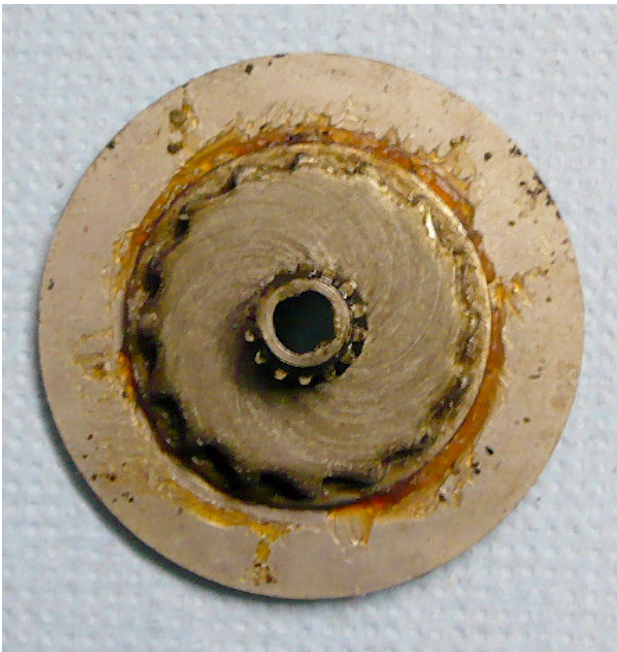
Vorderseite kurbelseitige Bremsdruckplatte
