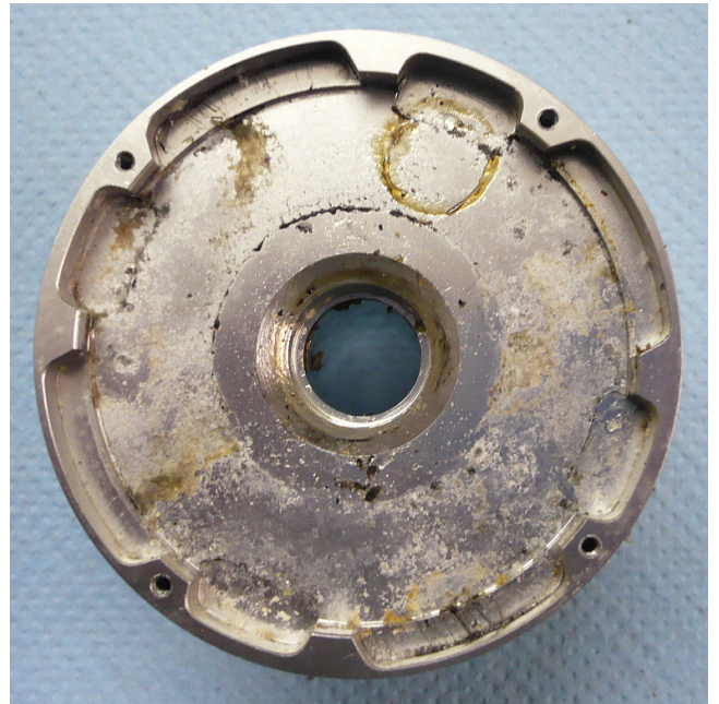
Spule rechts. Die dunklen Flecken sind Korrosion, Rest Salzablagerungen
