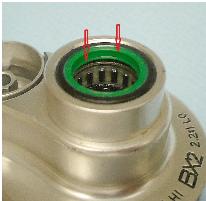
Die beiden Dichtlippen liegen am Drive Shaft eng an und verhindern das Eindringen von Seewasser.
