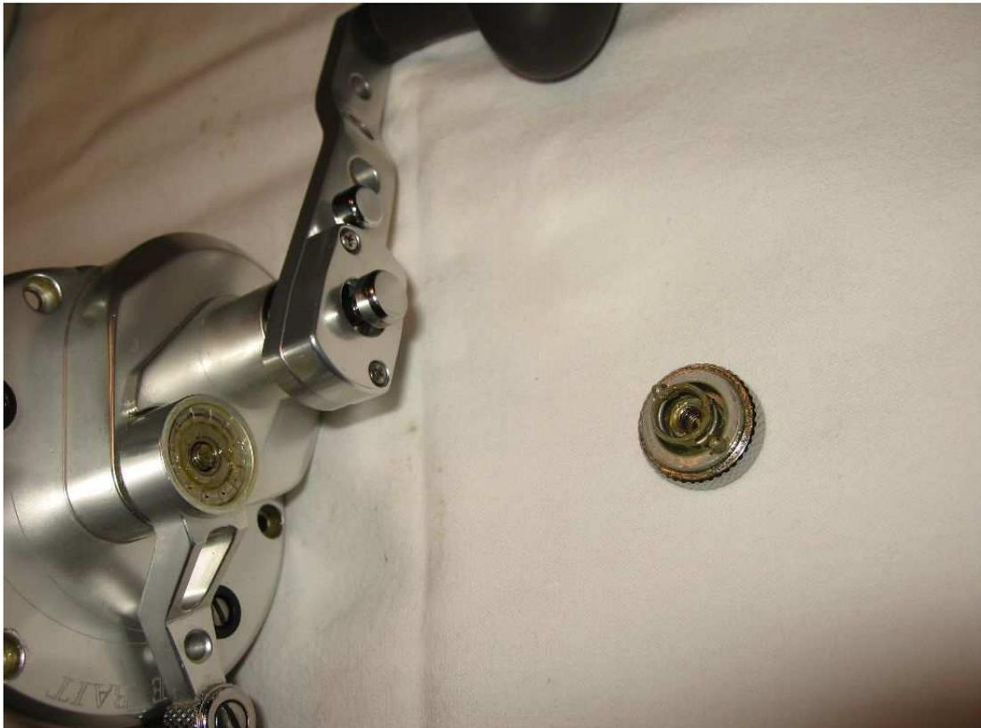
Jetzt kann man die Spule samt Achse herausziehen (Bild 7). Wenn dies vorsichtig geschieht, bleibt die Edelstahlbremsscheibe noch im Getriebeteil stecken. Sollte sich die Einheit schon lösen auch egal – einfach ablegen.
