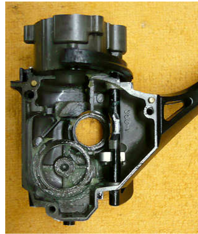
Beide Gehäuse unterscheiden sich nur durch die Durchführungen für den Umschalter. Die Black Arg war etwas besser gefettet als die Zalt Arc. Aber was sofort ins Auge gefallen und viel gravierender ist..... (s. nächste Bild).
