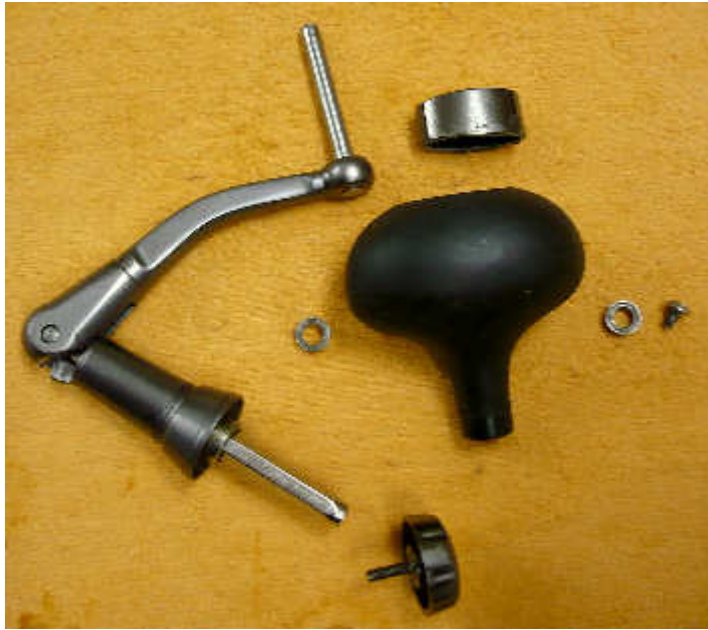
Stabile Kurbel mit Hartgummiknauf. Gelagert auf zwei Kugellager
