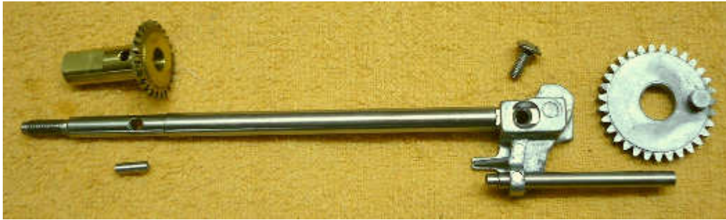
Die weiteren Getriebeteile. Exenterrad, Hubachse mit Slide mit eingesteckter und eingesteckter Führungsstange gegen Verwindung des Slide. Spulenaufnahme mit Sicherungsstift
