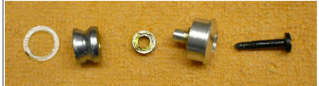
Hubstange wird in einem Kugellager geführt
