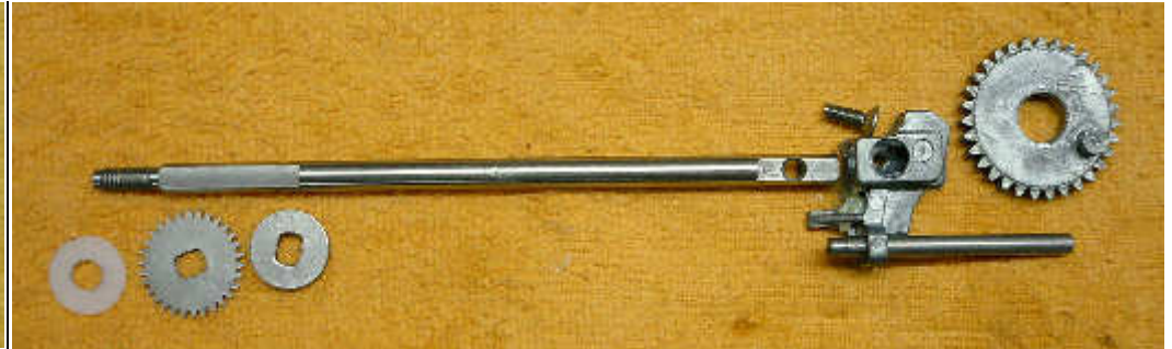
Exenterrad, Hubachse mit Slide mit eingesteckter und eingesteckter Führungsstange gegen Verwindung des Slide. U-Scheibe, Ratschenrad, Distanzscheibe
