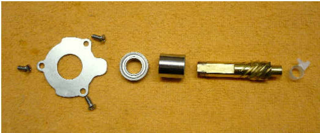
Alle Teile gleich (die Distanzscheibe ist auf dem Bild der Zalt Arc nicht mit abgebildet) Bei einer starken Meeresrolle muss das Ritzel beidseitig kugelgelagert werden. Die untere Plastebuchse ist ein No-Go.
