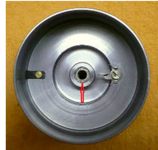
Hubstange wird in einem Kugellager geführt
