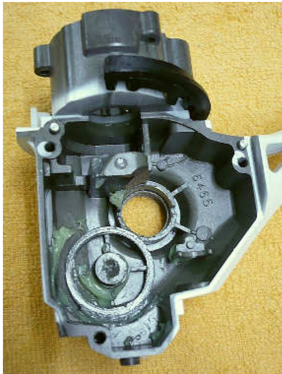
Beide Gehäuse unterscheiden sich nur durch die Durchführungen für den Umschalter. Die Black Arg war etwas besser gefettet als die Zalt Arc. Aber was sofort ins Auge gefallen und viel gravierender ist..... (s. nächste Bild).
