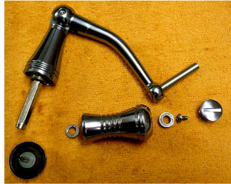
Der Kurbelknauf ist aus Metall. Gelagert auf zwei Kugellager. Das zu starke seitliche Spiel des Knaufs mit einer Paßscheibe korrigiert.
