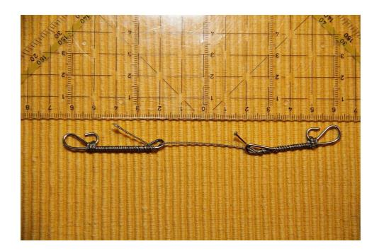
Der Schlitten des geeichten Testgerätes fährt in einer vorher definierten Geschwindigkeit langsam auseinander und misst exakt bei welcher Belastung (N = Newton) die Schnur reißt.
