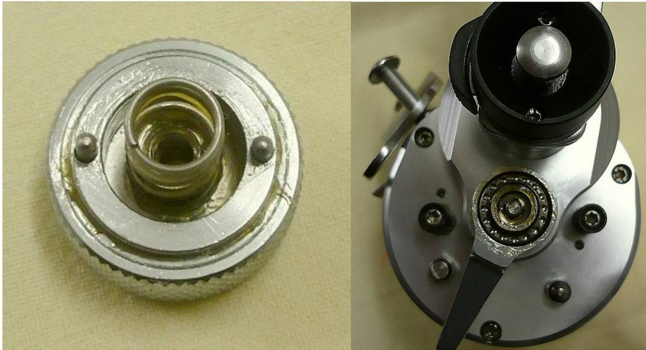
Presetknopf gegen selbständiges Verstellen durch Rasten gesichert
