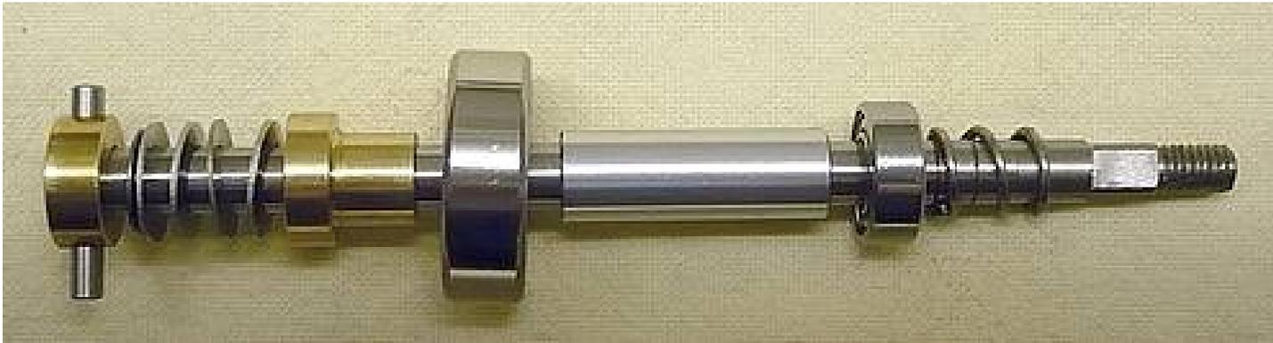
Durch die Führungshülse (Bearing Sleeve) zwischen den beiden Kugellagern wird verhindert das sich Druck auf die inneren Ringe der Kugellager aufbaut. Die axiale Last auf die Lager wird verringert und der Freilauf der Spule verbessert. Das bekannte Binding bei höher eingeschobener Bremse wird dadurch verringert oder eliminiert.
