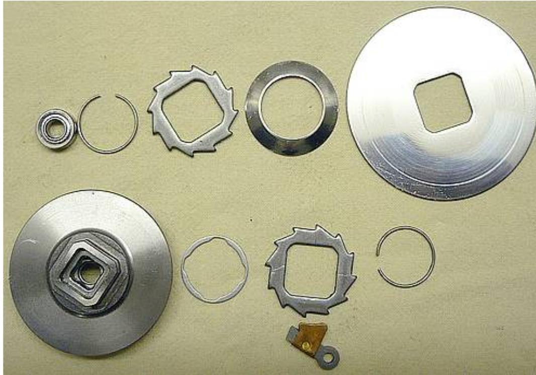
Teile der Bremsdruckplatte mit Notrücklaufsperr (Dog)
