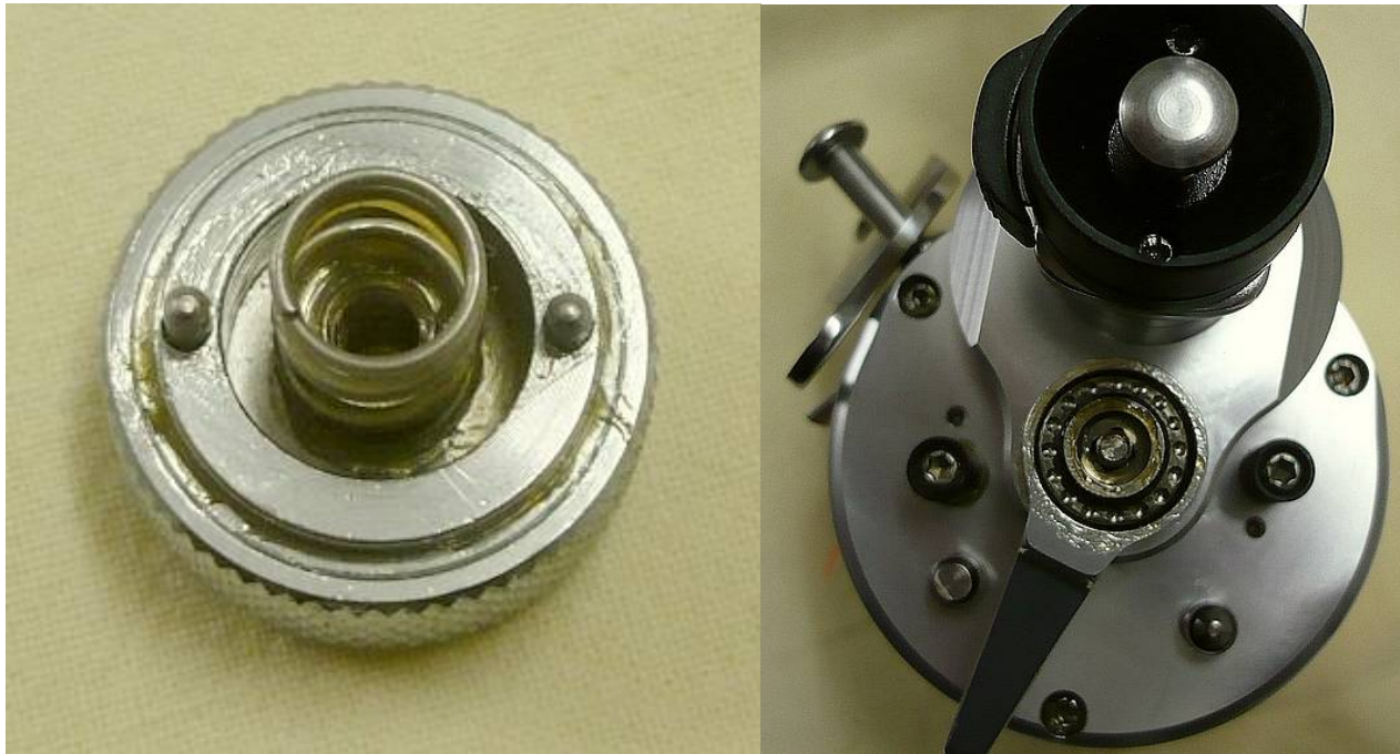
Presetknopf gegen selbständiges Verstellen durch Rasten gesichert
