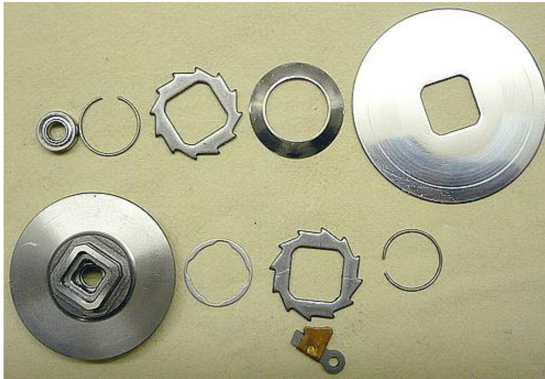
Teile der Bremsdruckplatte mit Notrücklaufsperr (Dog)
