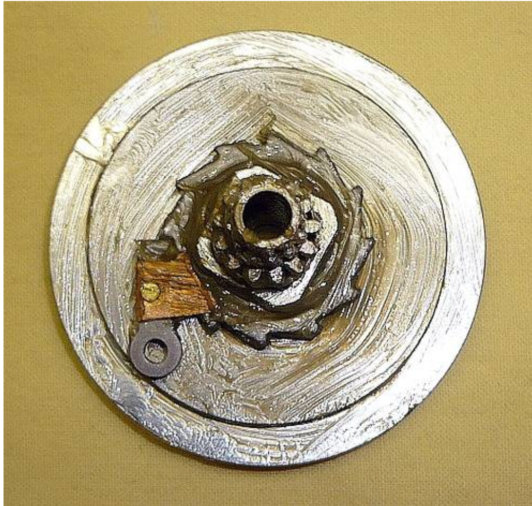
Stellung des Dogs bei der Montage (bereits einsatzfertig gefettet) Etwas Fett auf die Lippen des Dogs verhindert das Abfallen beim Einsetzen in den Gehäusedeckel. Durch die Führungslippen kurbelt die Rolle silent was die eigenen Nerven und die der Mitangler schont! Lange so etwas gesucht.
