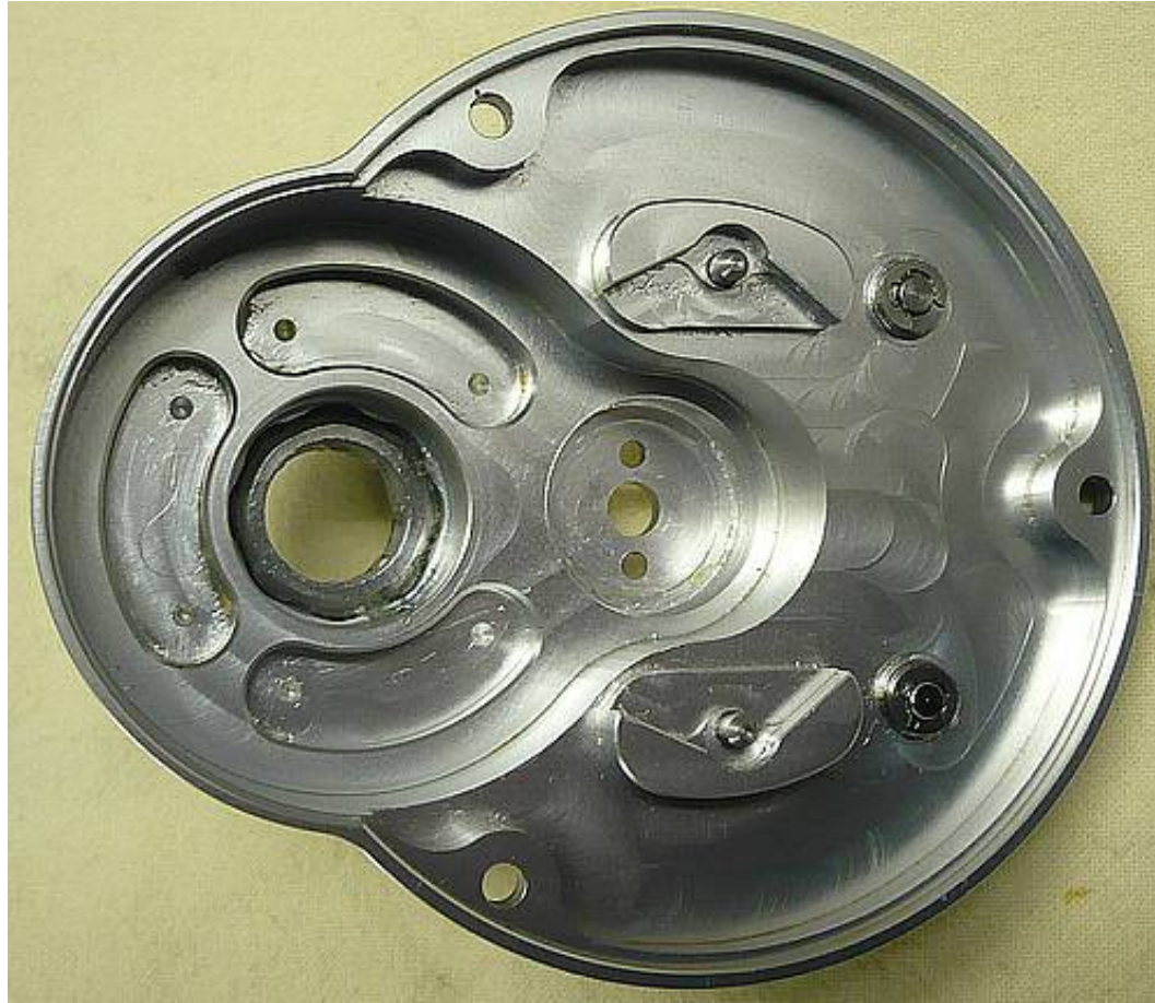
Sauber gefräster Gehäusedeckel. Die Kugellager lassen sich spielfrei ohne Druck einlegen Werkseitig war das komplette Innengehäuse ausreichend gegen Korrosion gefettet.
